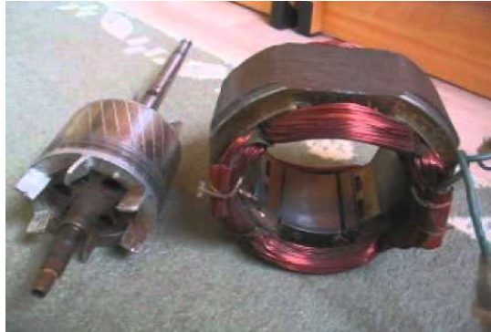
الشكل رقم (2-1): العضو الثابت والعضو الدوار لمحرك حثي أحادي الوجه
